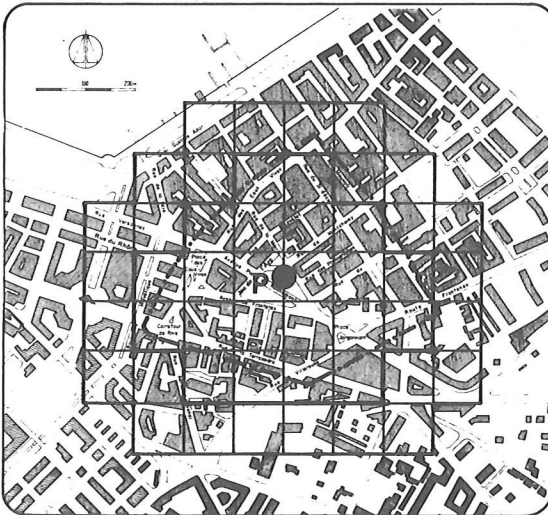
Fig. 5 : Exemple de périmètre d'étude pour l'analyse des caractéristiques socio-économiques d'un garage collectif. Le périmètre géographique, de 150 à 200 m de rayon à partir du projet, est inscrit dans la trame hectométrique CUB (carré unité de base).
